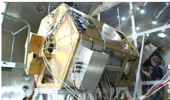
Fig. 1. VASIMR<sup>®</sup> VX-200i prototype.
